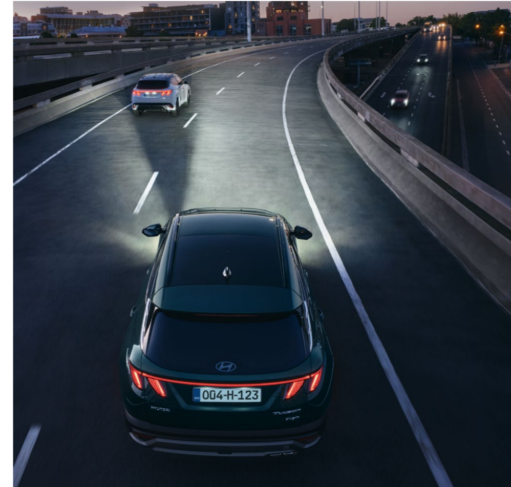
Inteligentni sistem prednjih svjetala pruža najbolji nivo osvjetljenja, koji se automatski prilagođava stanju na cesti i maksimizira upotrebu dugih svjetala kada nema vozila koja nam dolaze u susret.
