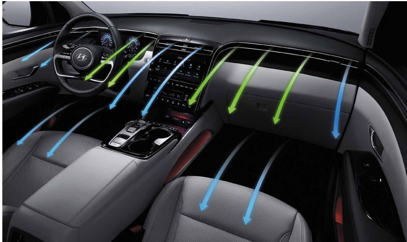
Višestruki zračni mod sa zračnim ventilima postavljenim indirektno.
