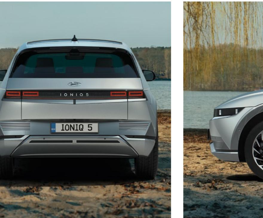
Parametrička piksel LED zadnja svjetla.
